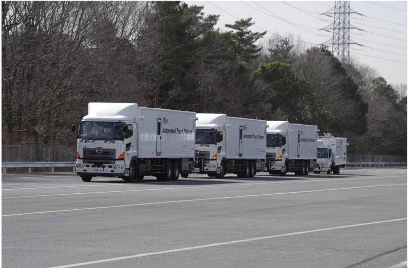
「エネルギーITS」で試作された3台の大型トラックによるプラトーン走行 (4台目の小型トラックも自動運転可能)
