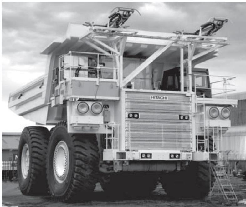
トロリー式ダンプトラックの概観
