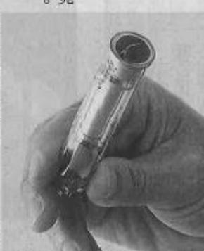
HARP撮像管。黒っぽい円形の部分がエックス線など電磁波を受け止める半導体製の「受光面」(NHK提供)
